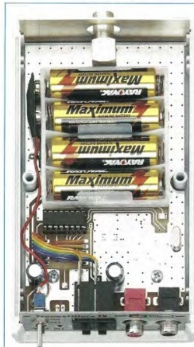
Fig.7 Foto del circuito stampato del trasmettitore collocato nel suo mobile e con le pile da 1,5 volt inserite nel loro vano.
