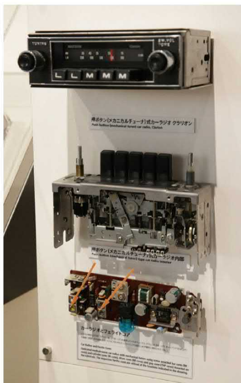
懐かしい押しボタン式車載用ラジオ。メカ式チューナーにはビス付き棒状コアと円筒コアが、中波専用チューナーにはドラムコアとギャップコアがそれぞれ搭載されている。それらのフェライトコアがTDK製だった。
