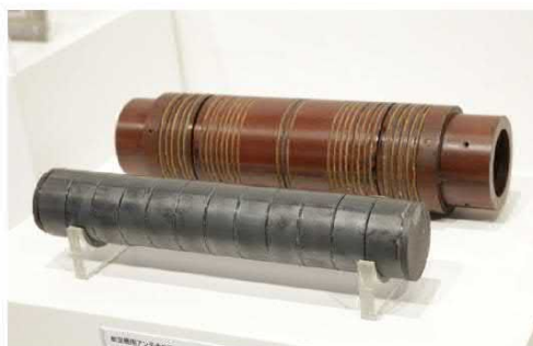
第二次世界大戦中の航空機用アンテナコア。当時の軍用機の基地帰投用テレフンケン型アンテナには、ドイツでは圧粉磁心（ダストコア）が使われていたが、日本ではTDKのフェライトコアが採用されていた。
