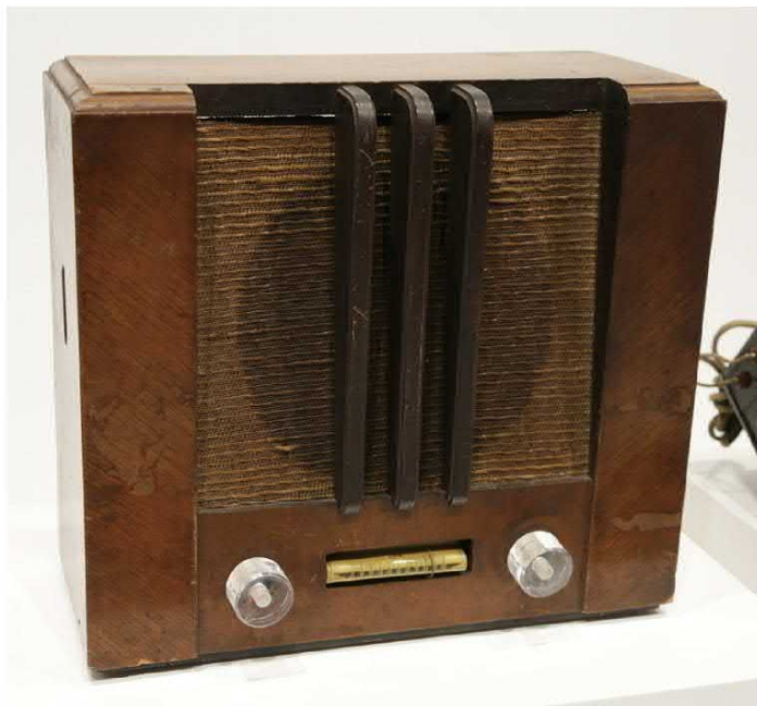
1940年のナショナル受信機R-4M同調回路はコンデンサとコイルで構成されるが、コイル内のフェライトロッドが移動して同調する仕組み。バリコンが不要となる。そのフェライトロッドをTDKが大量生産していた。
