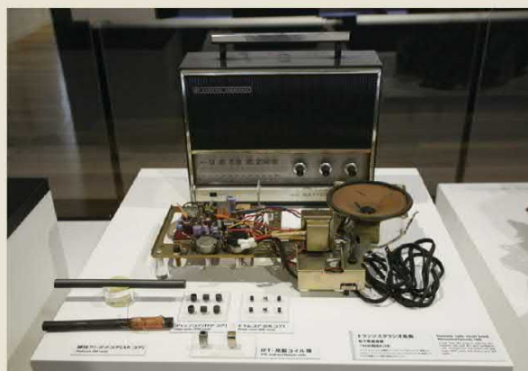
1968年の松下電器製トランジスタラジオの基板。棒状アンテナのコア、IFT・発振コイルにはギャップコア、ドラムコアも内蔵されている。ラジオにもTDKのパーツが使われている。
